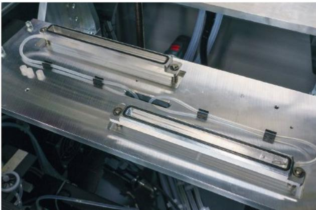
Sistema de "Capping" de impresión para una limpieza más eficaz y una mayor protección en espera.
