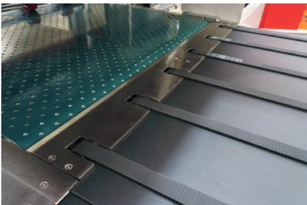
El amplio sistema de transporte por cinta de vacío garantiza impresiones precisas y un movimiento constante del material.
